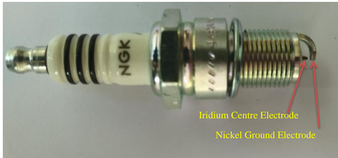
Fig. 4.4. Iridium Spark Plug
