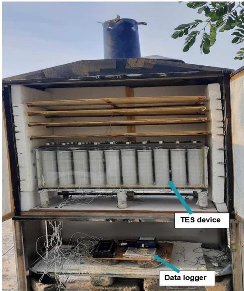
Fig. 3.6. The actual TES device in the drying chamber
