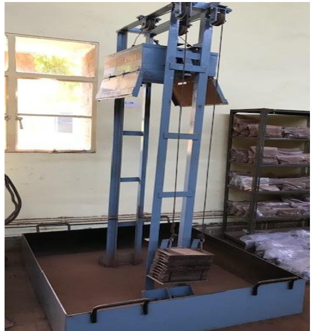
Fig.3.24 Shatter Index test apparatus
