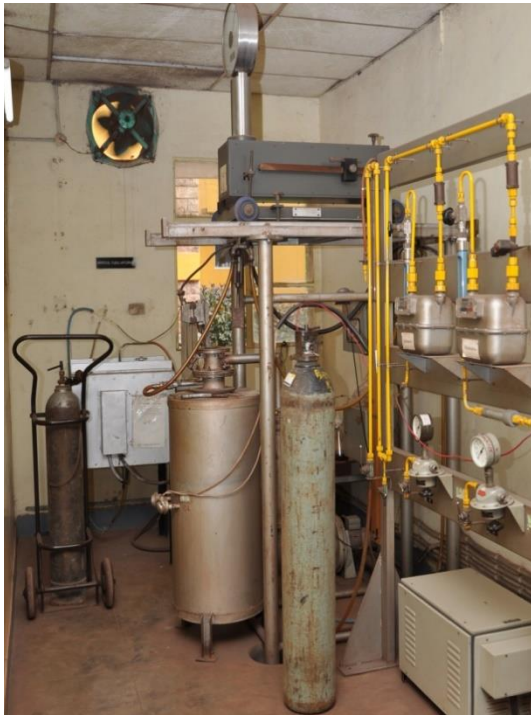
Fig.3.26 RI/RDI furnace (Lurgi) Italy make
