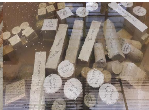
4.4 (d) Curing of specimens
