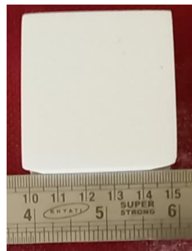
Fig.4.15.: CIP ed Alumina Sample.
