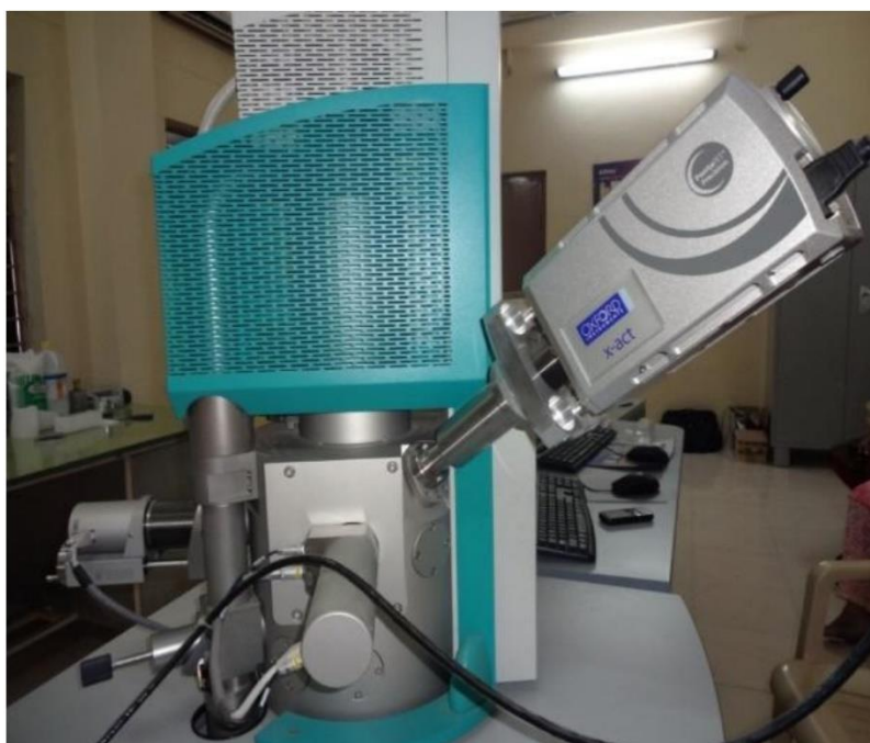
Fig. 3.11. SEM equipped with EDX
