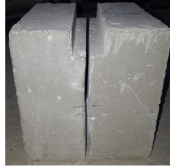
(d) With guide notch specimen
