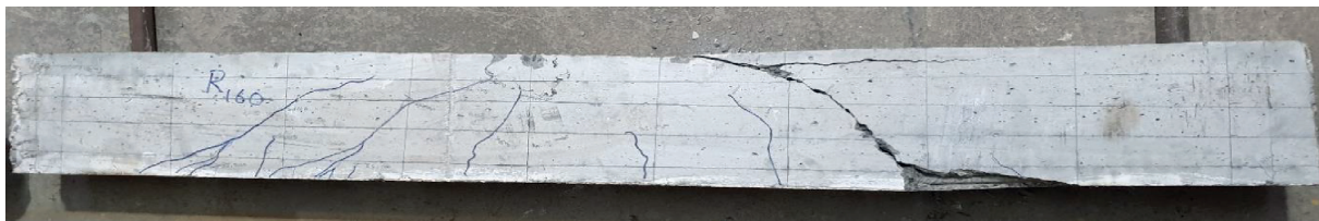
b) R160 Wzorec pęknięcia belki - zniszczenie przez ścinanie b) R160 Beam crack pattern at ultimate – failed in shear
