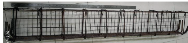
Rys. 4 (d). Belka L160 - konwencjonalny układ wzmocniony wzdłużnie siatką stalową
