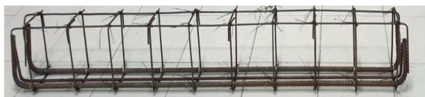
Rys. 4 (c). Belka R160 - konwencjonalny układ zbrojenia, powiększony rozstaw strzemion
