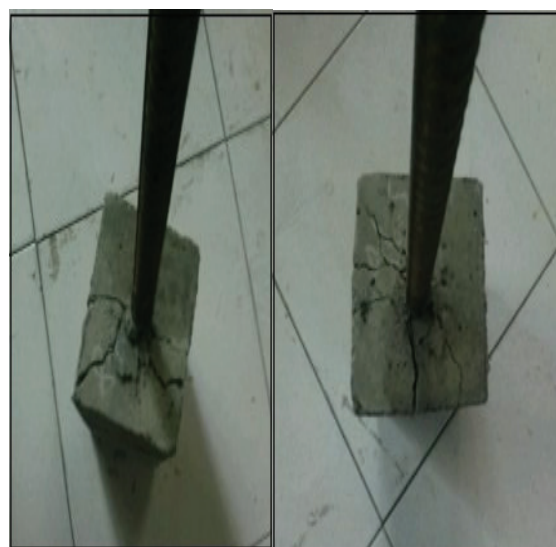
Rys. 5. Uszkodzenia próbek po badaniach
