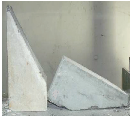
Rys. 8. Zerwanie przyczepności w zespolonej belce
